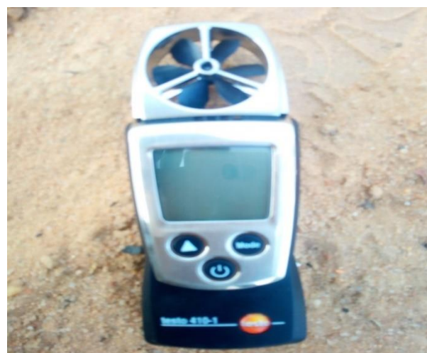
Figure 3-5 et 6: Photos Anémomètre à hélice Testo410-1 de Labo de l'UDDM
