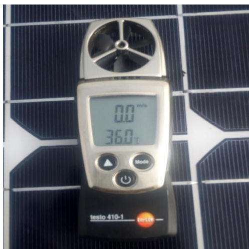
Figure 3-5 et 6: Photos Anémomètre à hélice Testo410-1 de Labo de l'UDDM
