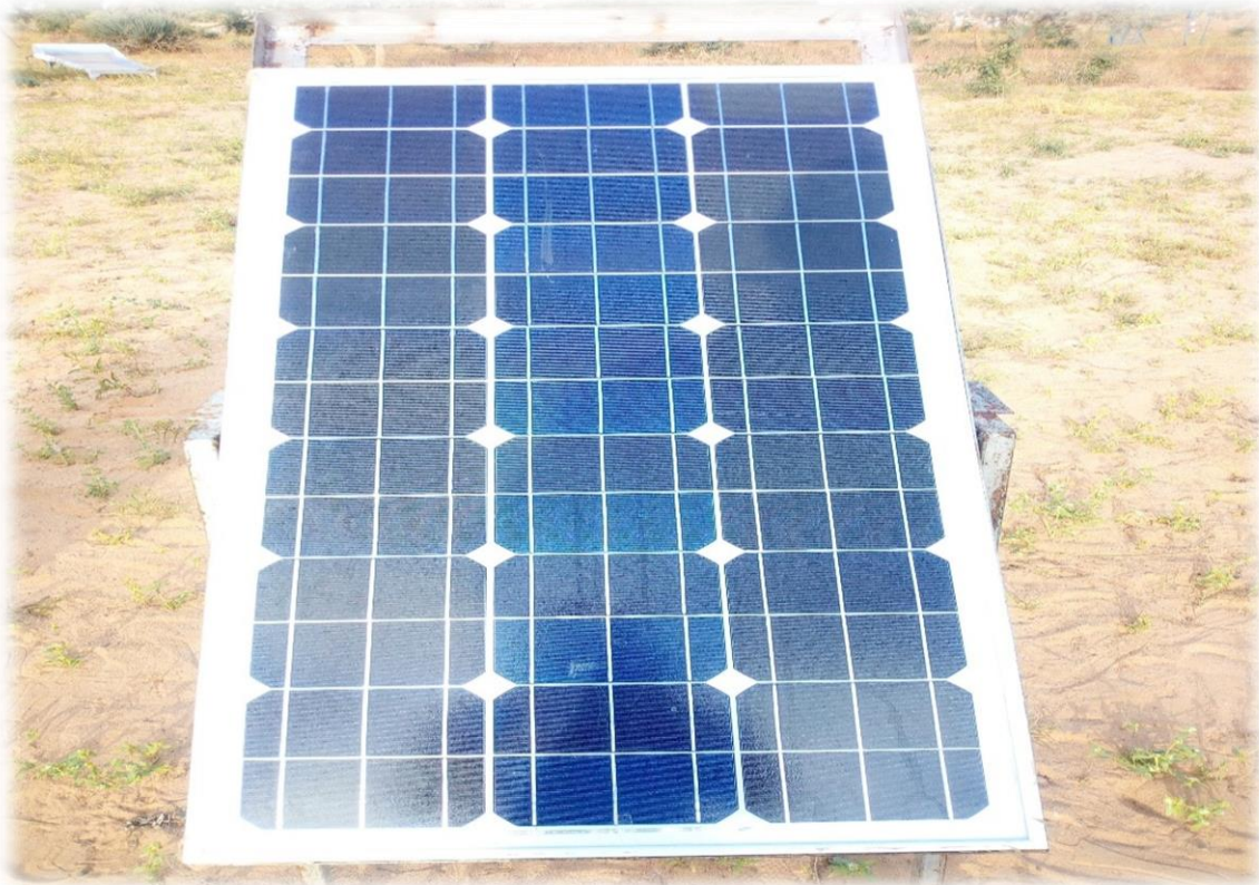
Figure 3-4: Photo d'un module PV SA-80 à l'UDDM
